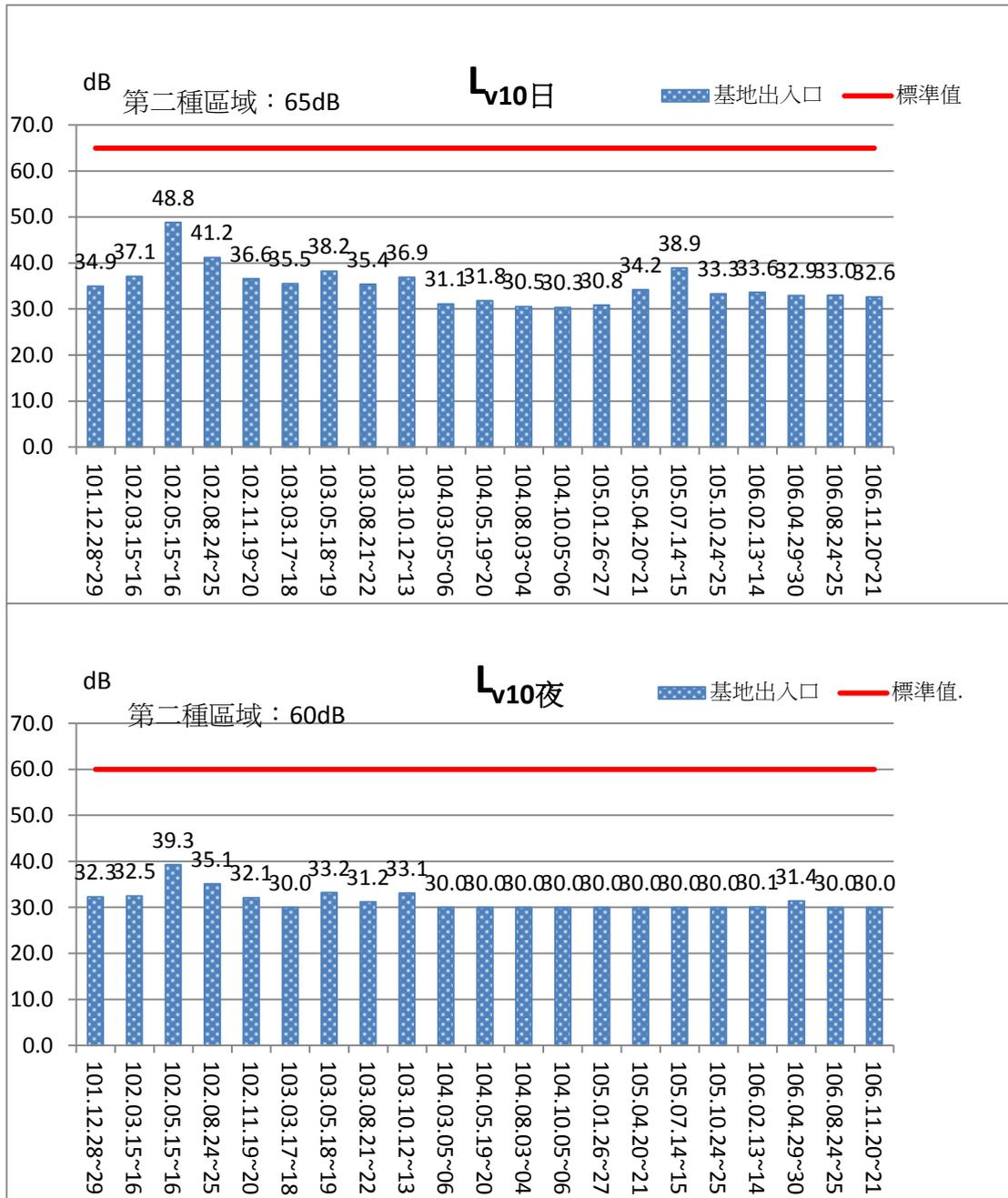
圖 2.2-3 基地出入口振動監測結果比較圖
