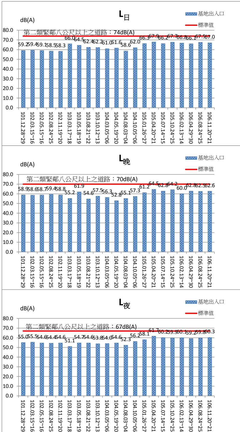
圖 2.2-1 基地出入口噪音監測結果比較圖
