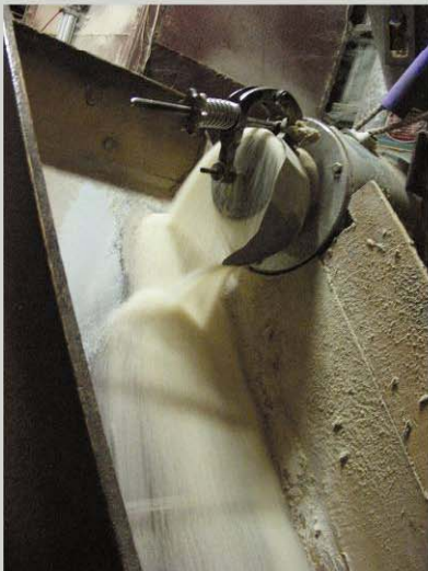
米絞機具碾出白米的情形 圖片來源：廖倫光提供
