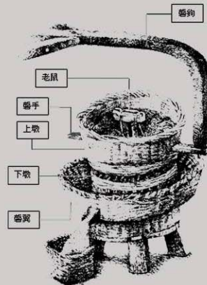
泥礮構件細部圖說 《陳乃中·廖倫光繪》
