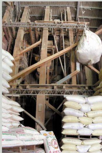
運作中的礱間流籠 圖片來源：廖倫光提供
